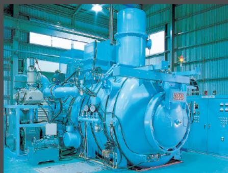
二室式急速冷却型真空焼入れ炉
