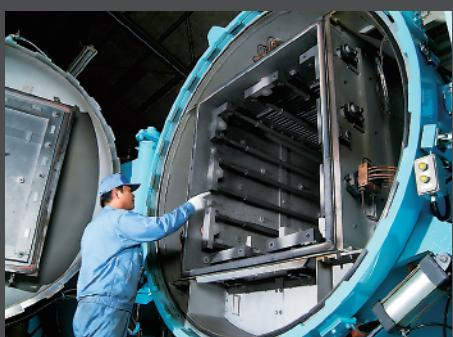
一室式大型対流加熱真空焼入れ炉
